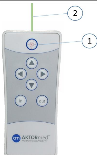
Abb. 4: LASERTASTE und LASER POINTER der FERNBEDIENUNG
