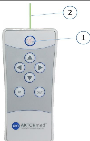
Fig. 4: BOUTON LASER et LASER POINTER de la TÉLÉCOMMANDE
