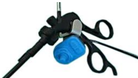
Figura 4: JOYSTICK en el instrumento quirúrgico
